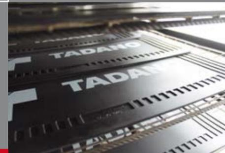
Hierbei wird eine Spezialfarbe im Siebdruckverfahren aufgetragen und dauerhaft eingebrannt (möglich ab 50 Satz eines Designs).
